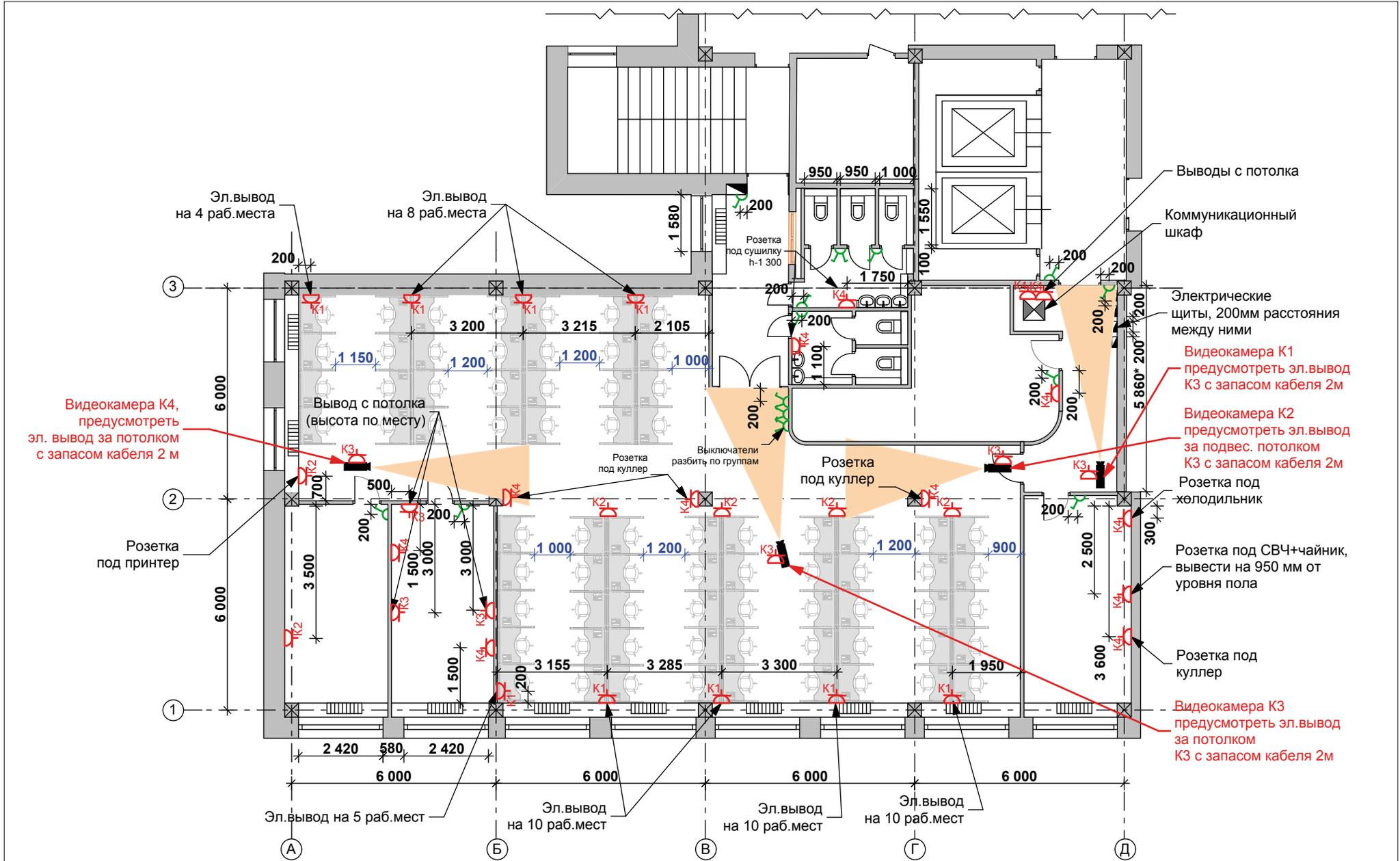
Видеокамера K4, предусмотреть эл. вывод за потолком с запасом кабеля 2 м
