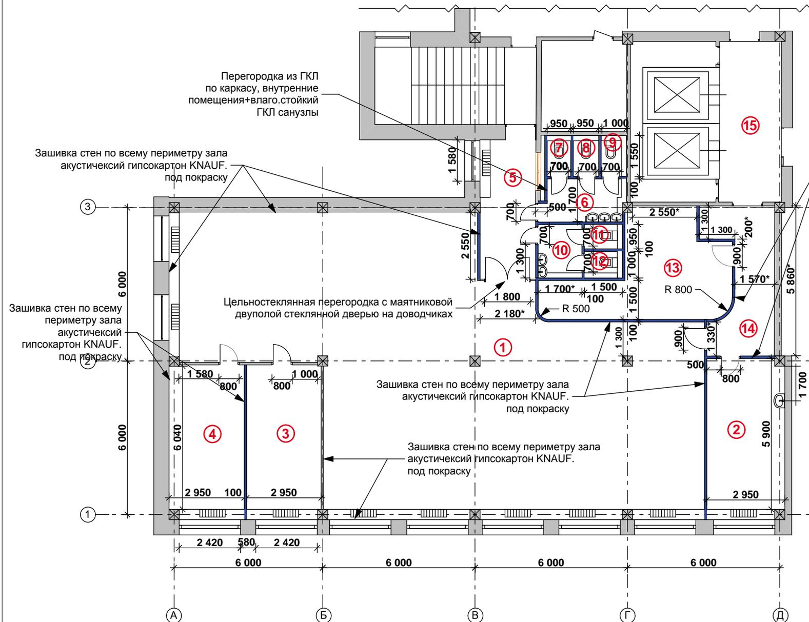
Перегорodka из ГКЛ по каркасу, внутренние помещения+влаго.стойкий ГКЛ санузлы
