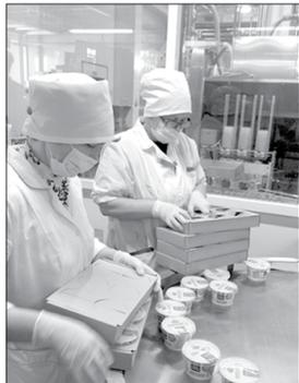
Стоимость проекта составила 20 млн рублей. Линия PACK LINE (Израиль) включает асептические участки подготовки смеси, созревания продукта и фасовки на высокоскоростном автомате производительностью 60 стаканов в минуту. За счёт создания специального микроклимата в цехе, максимально стерильным условиям в боксах закваски и созревания срок годности сметаны увеличился до 21 дня без использования консервантов.
